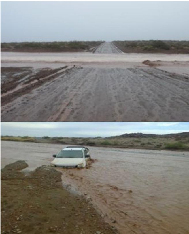
**Técnica 6:** Evaluar si se puede pasar, se analiza. Si hay riesgos no intentar. Si se toma la decisión en tracción simple en primera a muy baja velocidad. Si el vehículo posee 4x4 pasar en baja en primera a muy baja velocidad tratando de no generar olas.
