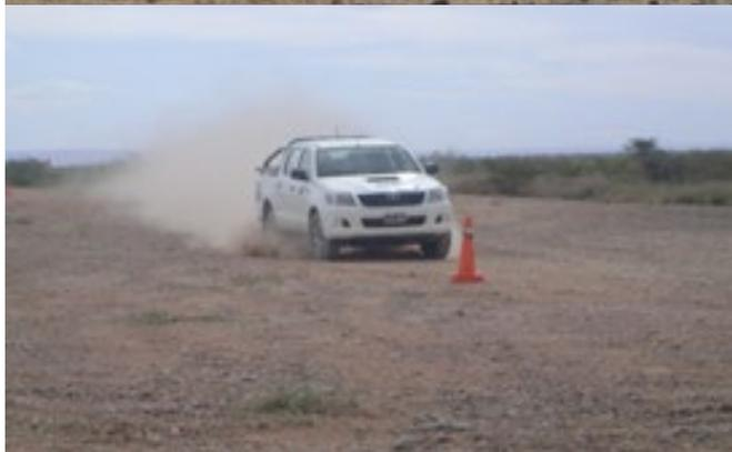
Con sistema ABS o sin sistema ABS la técnica es frenar con el pedal a fondo, no se tiene control de la dirección y para obtener nuevamente la dirección y poder esquivar un obstáculo debo soltar el pedal de freno y volante suavemente.
